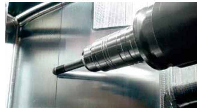
形状加工(模具等) 高韧性材料(40HRC)的半精加工 φ16球头立铣刀
