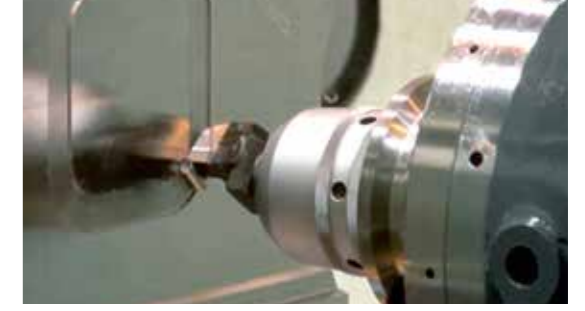
CS控制无痕加工 超硬车刀 材质:SUS3040
