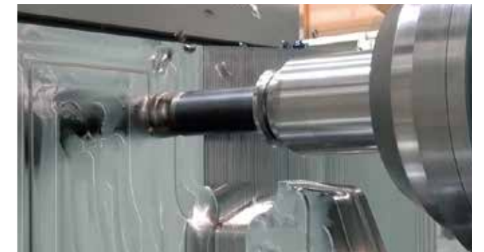
形状加工(模具等) 高韧性材料(40HRC)的高效粗加工 φ63快进给铣刀
