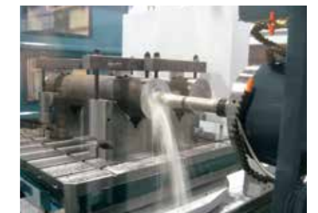
深孔钻加工 φ110快锋机夹式钻头/材质:S55C
