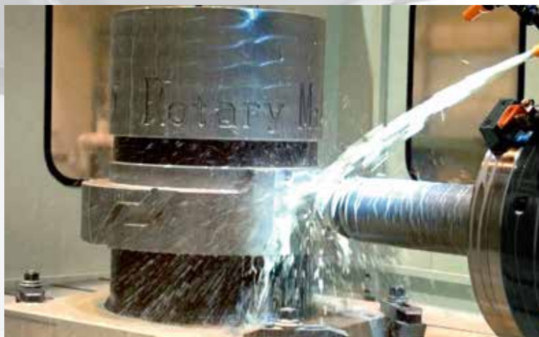
连续旋转加工 标准即可实现工作台的旋转切削加工
