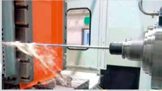
MC枪钻加工 φ16枪钻/加工深度:800mm
