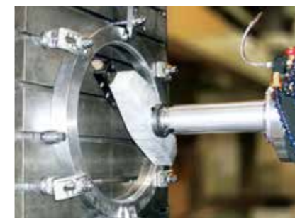
大直径镗削加工 φ624mm(W=350)/材质:S55C
